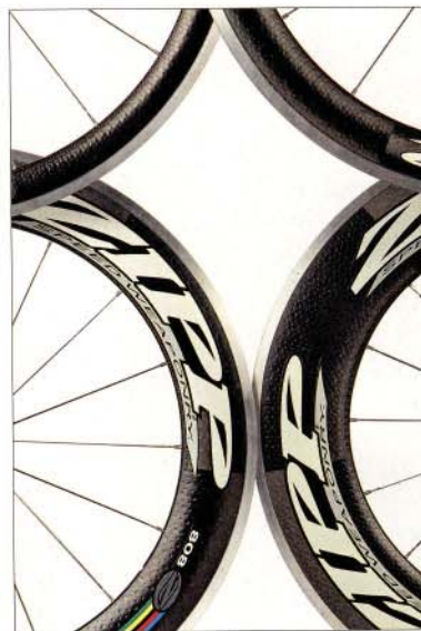
Der Trick: Die Ausbuchtung der Felgen unterhalb der Bremsflanke verbessert die Aerodynamik
